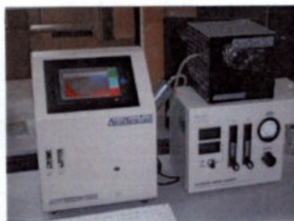
Рисунок 48. Аппаратура для передачи и воспроизведения единиц дисперсных параметров наночастиц в аэродисперсной среде, реализующая метод диффузионной аэрозольной спектроскопии
