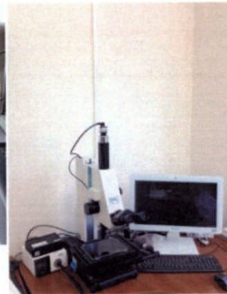
Рисунок 26. Измерительный микроскоп (погрешность измерения диаметров отпечатков \pm 0,2 мкм)
