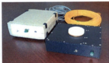
Рисунок 54. Радиооптический измерительный преобразователь напряженности импульсного электрического поля
