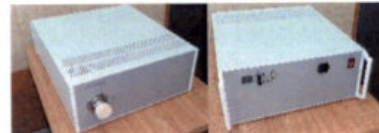
Рисунок 55. Полупроводниковый генератор импульсов высокого электрического напряжения (длительность фронта импульсов не более 100 пс, амплитуда импульсов до 50 кВ)
