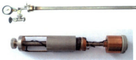
Рисунок 34. Базовый погружной криостат БКД со сменной ячейкой теплопроводности
