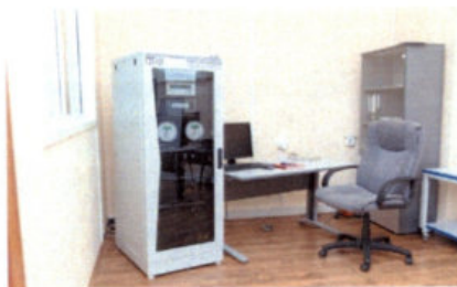
Рисунок 38. Пульт управления эталонным генератором, реализующим метод фазового равновесия, и эталонным генератором в области отрицательной температуры термостатирования
