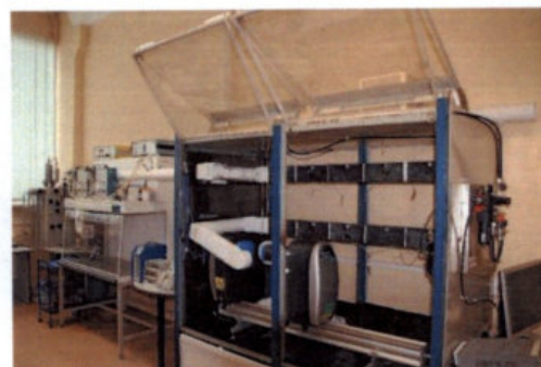
Рисунок 49. Аэрозольные камеры с пневматическими, ультразвуковыми и пневмомеханическими генераторами частиц различных физико-химических свойств.
