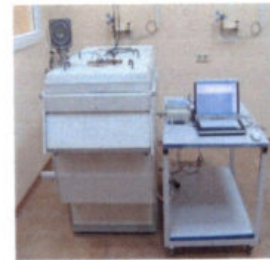
Рисунок 39. Эталонный генератор влажного газа в области положительных температур термостатирования
